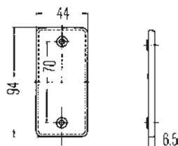
Fissaggio a vite: Ø 4,3 mm
