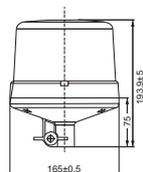
Fissaggio con raccordo tubolare
