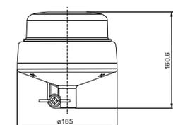
Fissaggio con raccordo tubolare
