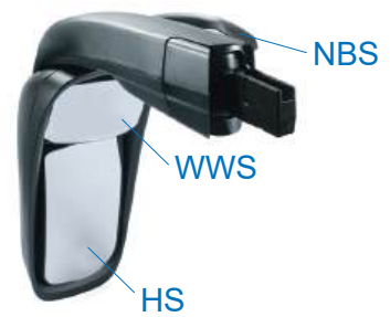
4 Spiegel mit HS, WWS und NBS (rechts) mirror with HS, WWS and NBS (right)
