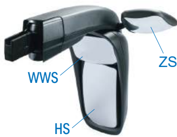
3 Spiegel mit HS, WWS und ZS (links) mirror with HS, WWS and ZS (left)
